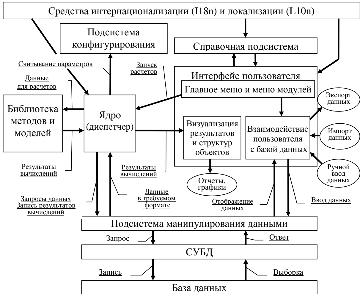
Рис. 1. Предлагаемая архитектура программного продукта
